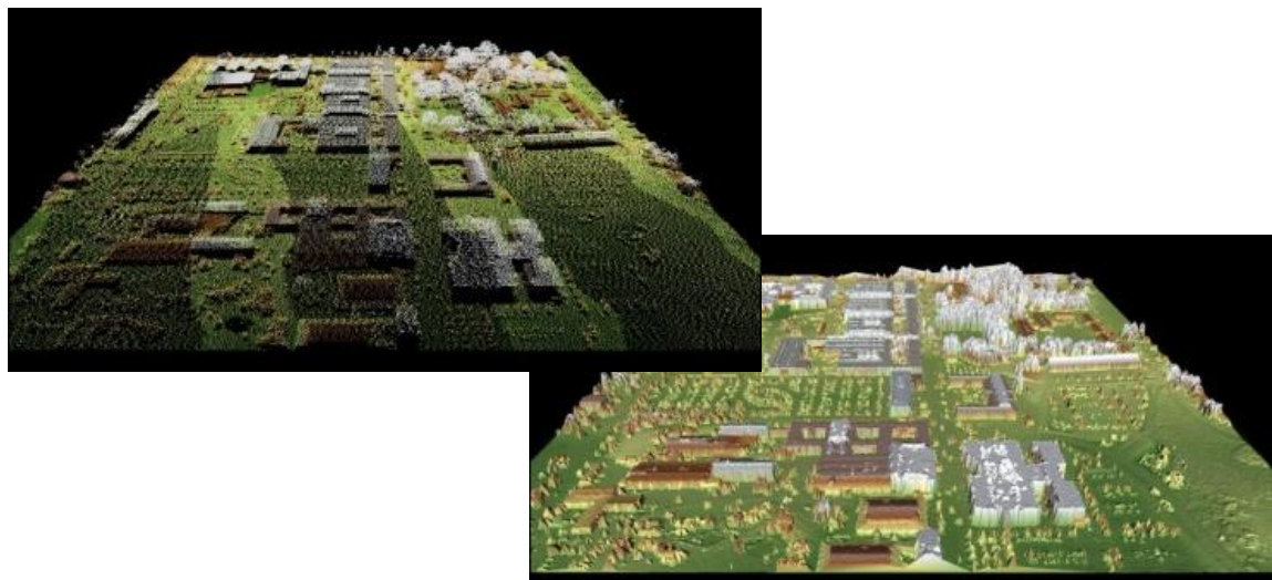
Figur 1: Laserdata över Linköping Universitet som punktmoln (vänster) och ytmodell baserat på punkterna (höger). Jämför gärna med 3D stadsmodellen på Linköpings kommun hemsida.
